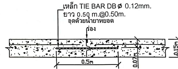
LONGITUDINAL JOINT
